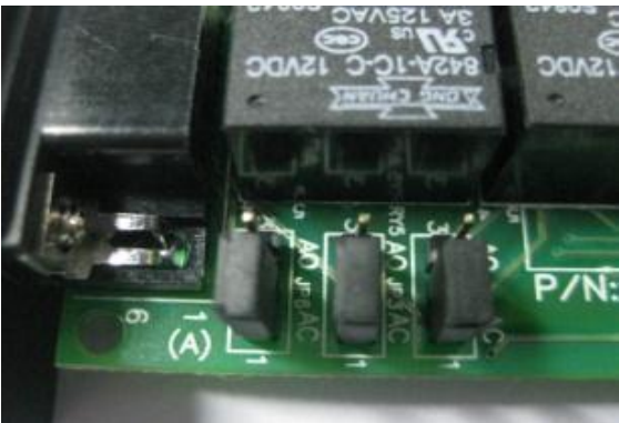
图 6 闭路状态的跳针设置
