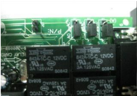
图 5 AO 与 AC 丝印显示 3-pin 连接器的状态
